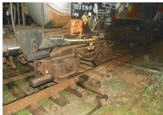
Fig.1 Vagonul al 3-lea în sensul de mers, cu ultima osie pe macazul nr.2 în dreptul încuierilor.
