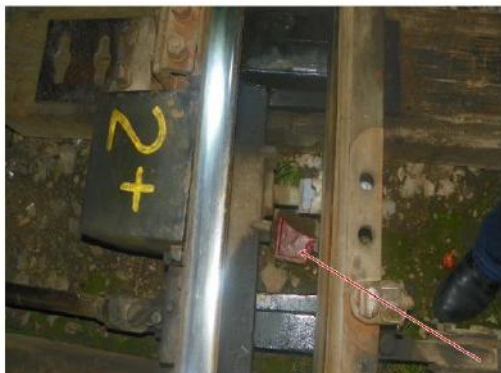
Fig.2 Ciocul rupt la încuietorea pe „+” a macazului nr.2
