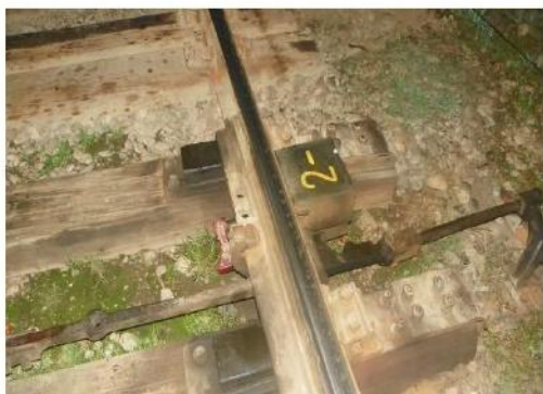
Fig.3 Încuietorea în poziția „-” a macazului nr.2
